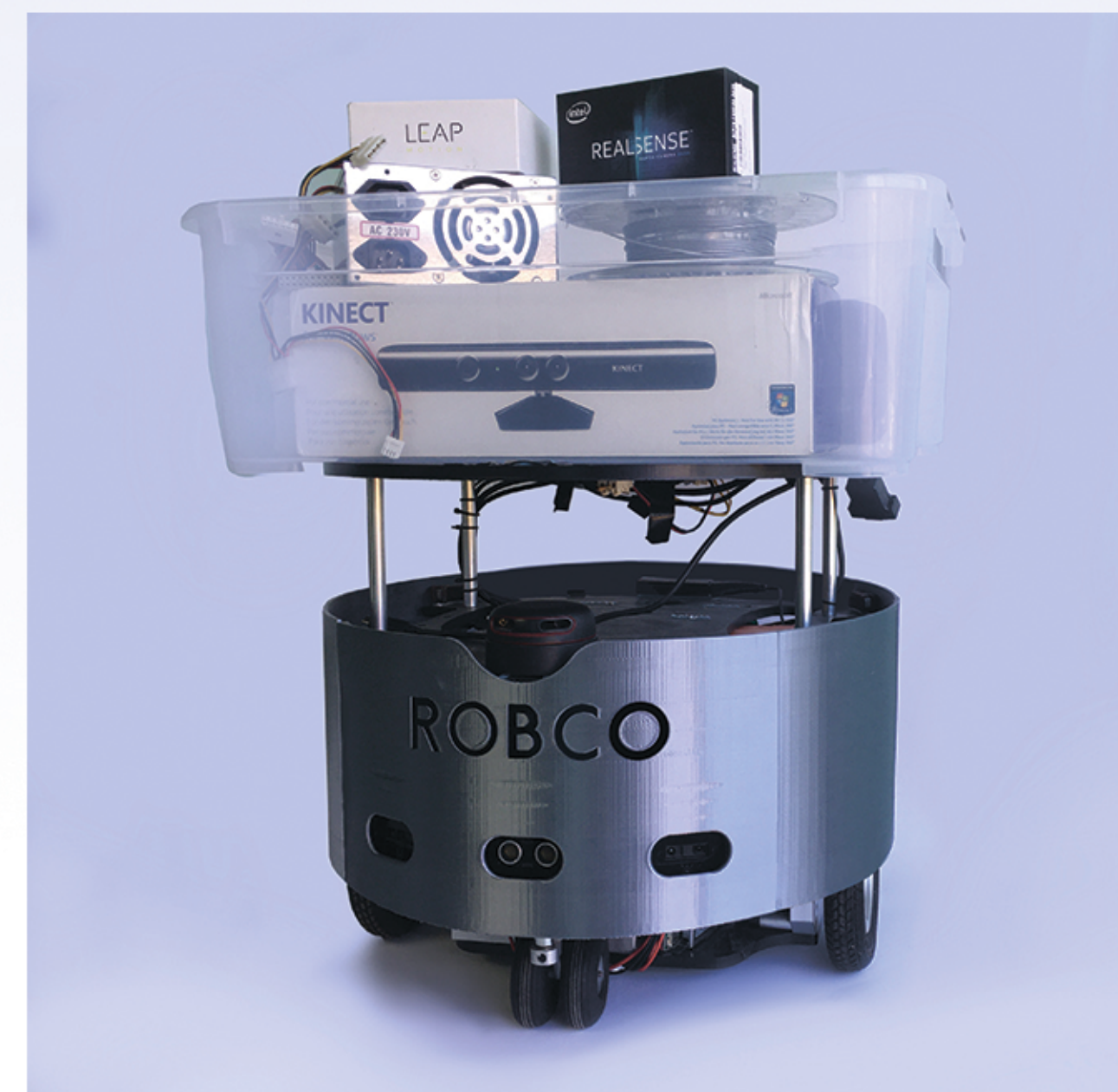
Концептуален дизайн на робот-дрон за транспорт на готова продукция
